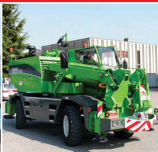
▲ Falcone telescopico 8,0 m Foldable fly jib 8,0 m Faltbare Klappspitze 8,0 m Extension télescopique répliable 8,0 m
